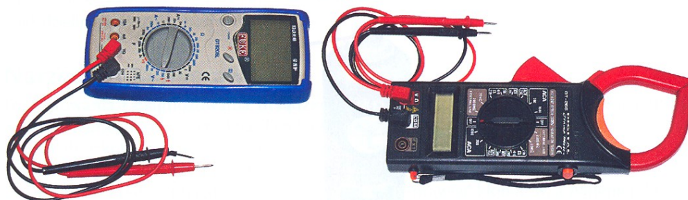
Rys. 1.6. Miernik elektroniczny: a) standardowy, b) cęgowy
