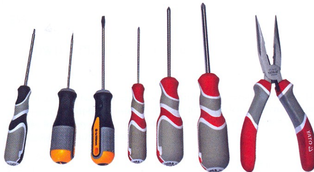
Rys. 1.1. Narzędzia do naprawy: wkrętaki krzyżowe, płaskie oraz szczypce
