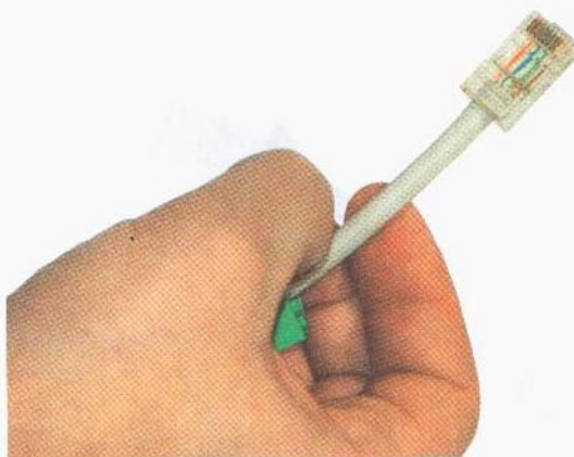
Rys. 37.9. Nałożenie wtyku na przygotowany kabel
