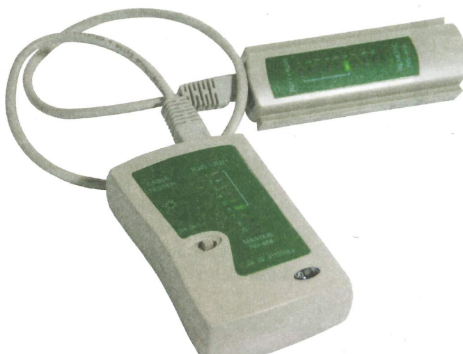
Rys. 38.2. Przykład pomiaru kabla miedzianego-skrętki
