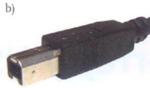
Rys. 2.2. Wtyczki kabla USB: a) wtyk typu A (do komputera), b) wtyk typu B (do urządzenia)
