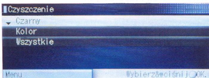
Rys. 18.1. Czyszczenie głowicy w urządzeniu wielofunkcyjnym
