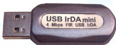
Rys. 3.6. Karta interfejsu (adapter) IrDA
