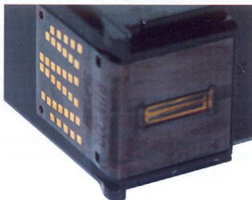
Rys. 18.2. Głowica drukująca w urządzeniu atramentowym (widok od spodu)
