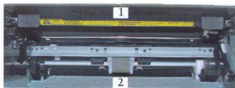
Rys. 7.2. Układ utrwalania papieru (1) i układ podający (2)
